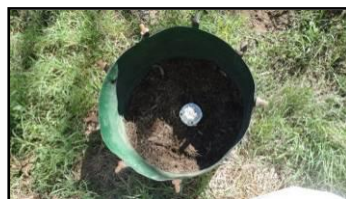
Foto 7. Tubo de lectura con anillo de lata clavado al suelo.
