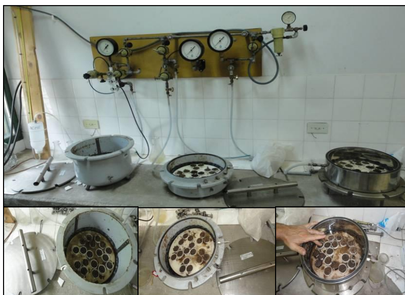
Foto 1. Equipo Richards (1947) “olla a presión”. Placas de 0,3 bares, 5 bares y 15 bares.
